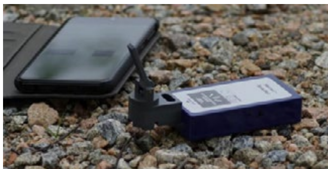
Kuva 4.3. MINIME- projektissa kehitettiin mittalaitetta nikkelin mittaamiseen.
