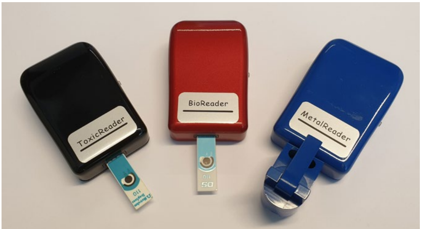
Kuva 5.1. CEMIS-hankkeessa kehitettiin ja valmistettiin kolme lukijalaitetta (HYTELI-> Bioreader, INNOBIO->Toxic reader, MINIME->Metalreader)
