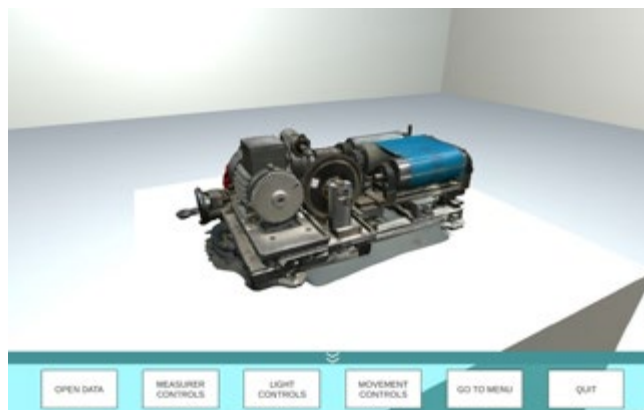
Kuva 4.4. Kunnossapitokoulutuksessa käytetyn demonstraatiolaitte (ns. setelipaino) virtuaalisena. Sovelluksessa opiskelija harjoittelee virtuaalilaseja käyttäen muun muassa värähtelyantureiden asemointia ja erityyppisen anturitiedon lukemista.
