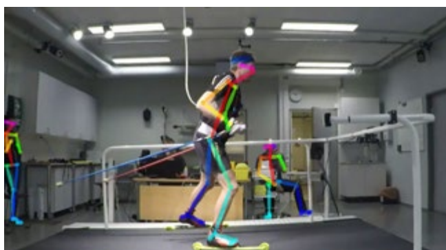
Kuva 9.2. CSC jatkokehitti HYTELI-hankkeessa urheilijan asentomallintamisen (human pose estimation) hyödyntämistä dynaamisen tasapainon testissä ja mattohihdossa.
