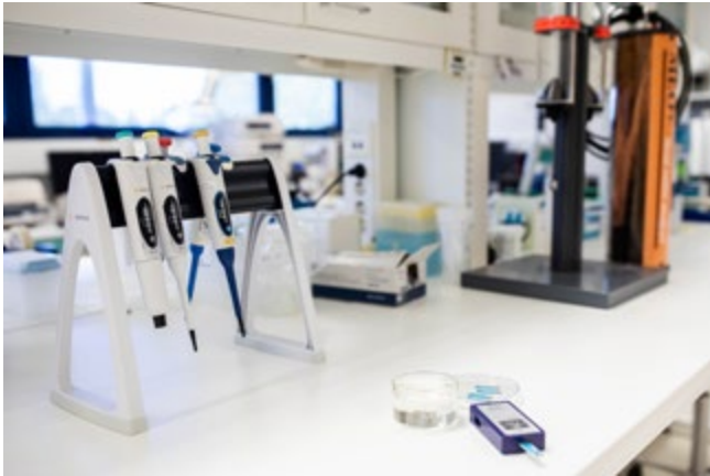
Kuva 4.2. MINIME-hankkeessa kehitetty pienikokoinen nikkelinmittaus laite ja siihen selektiivinen sensori.
