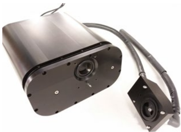
Kuva 4.6. KAIMIT-hankkeessa ideoitu, suunniteltu ja toteutettu optinen monimittauslaite nesteiden analysointiin. Kuvassa näytekammiot irrotettuna mittauslaitteesta.
