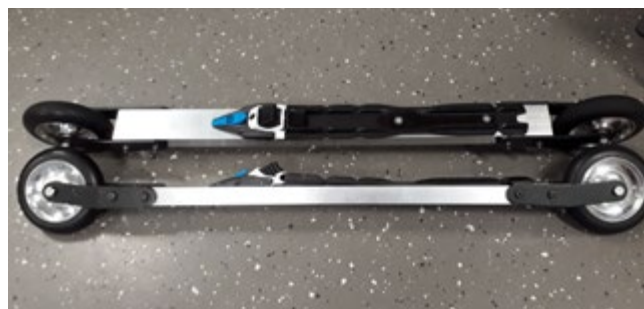
Kuva 8.2. HYTELI-hankkeessa kehitetty prototyyppi alumiinirunkoisista testirullasuksista, joihin integroidaan voima-anturoinnit pyöräripustuksiin sekä rungon sisään.
