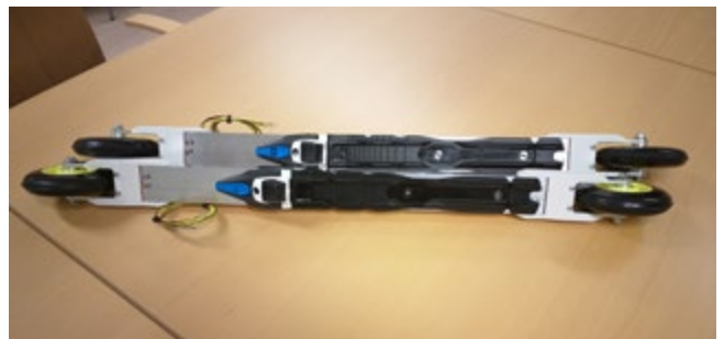
Kuva 7.3. HYTELI -hankkeessa suunniteltiin ja toteutettiin vapaan hiihtotyylin rullasuksen prototyyppi, jossa on pysty- ja sivuvoiman mittaaminen.
