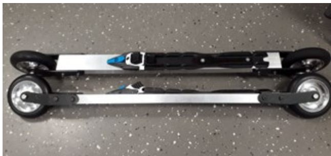
Kuva 4.5. HYTELI-hankeessa kehitetty prototyyppi alumiinirunkoisista testirullasuksista, joihin integroidaan voima-anturoinnit pyöräripustuksiin sekä rungon sisään.
