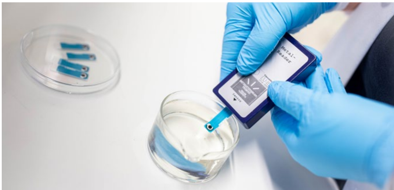
Kuva 5.1. MINIME-hankkeessa kehitetty pienten nikkelipitoisuuksien kenttämittauslaite ja sensori.
