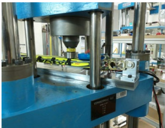
Kuva 7.2. Rullasuksien testimittaukset käynnissä 20 kN voimanormalissa VTT MIKES Kajaanissa.
