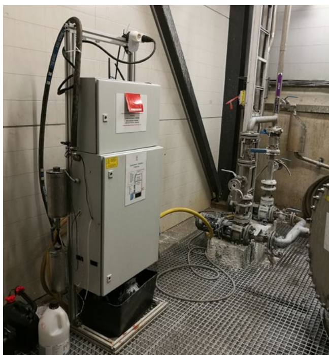
Kuva 4.1. MITYn kehittämä reaaliaikainen NIR mittalaite teollisuuden pilottikokeessa.
